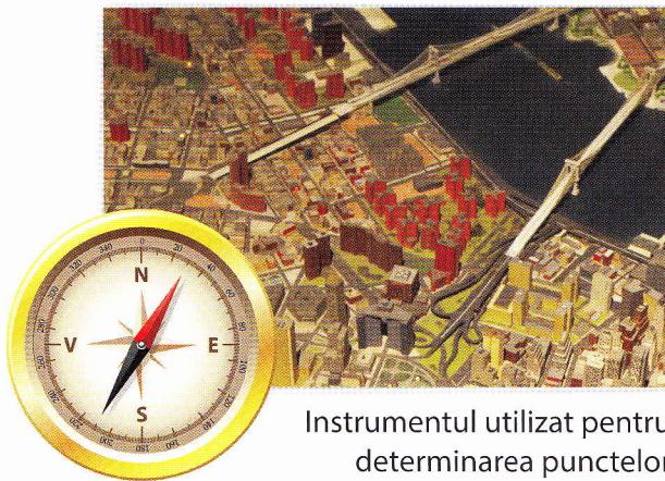
Instrumentul utilizat pentru determinarea punctelor cardinale se numește **busolă**.
